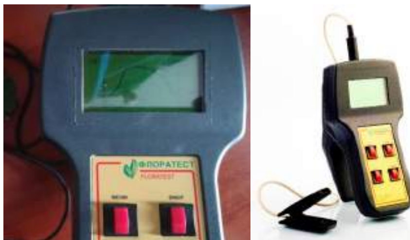
Рисунок 4.17 – Загальний вигляд портативного флуорометра «Флоратест» (зліва) та вимірювання показників флуоресценції хлорофілу на листках лабораторне вирощування).
