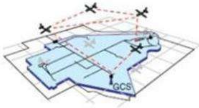
Рис. 5. Зв'язок БПЛА через мережі Ad-Нос
