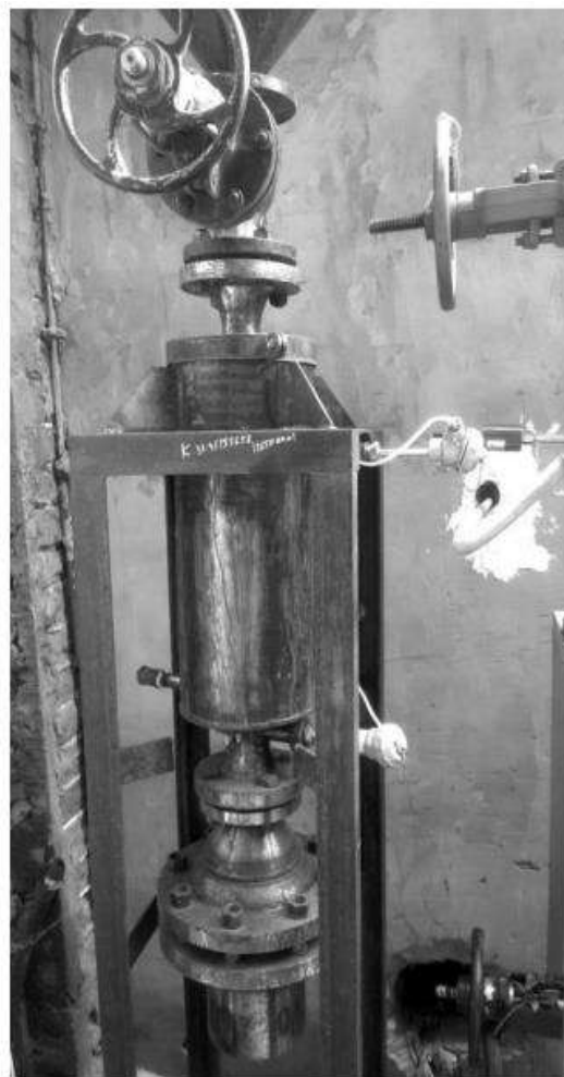
Рис. 2. Установа для паровибухової обробки деревини: а - складальне креслення, б - зовнішній вигляд [3]
