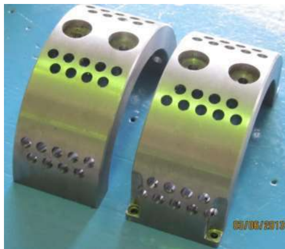
Рис. 3 - Циліндрична матриця d = 8,0 мм
