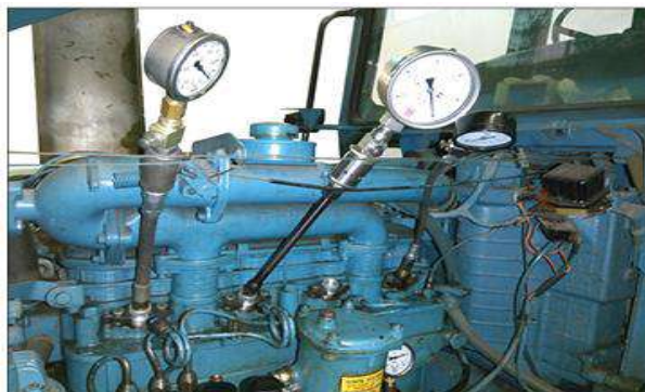
Рис. 7 - Підключення приладів комплексу АГЦ
