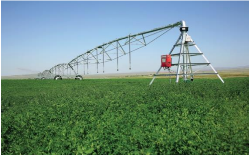
Рис. 2. Загальний вигляд кругової дощувальної машини.
