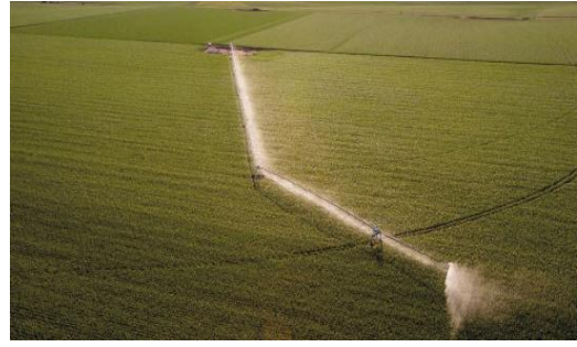
Рис. 3. Вигляд основного і кутового крил дощувальної машини.
