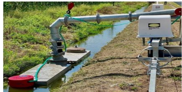
Рис. 5. Конструкція для постачання води вмонтованою помпою для фронтальних дощувальних машин.
