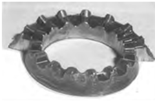
Рисунок 3.7 – Вид кілець після прямого витискування торцевого профілю методом ШО і відрізання частини зовнішнього кільця
