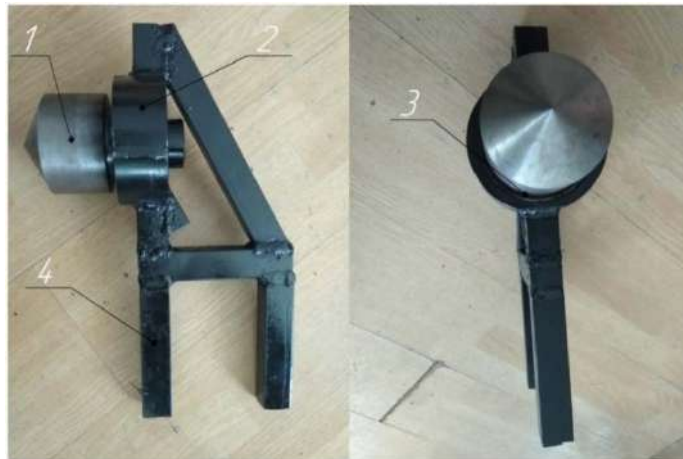
Рисунок 4.11 – Обкочувальна приставка до токарно-гвинторізного верстата: 1- валок, 2 – фланець, 3 – підшипниковий вузол, 4 – тримач Джерело: сформовано автором
