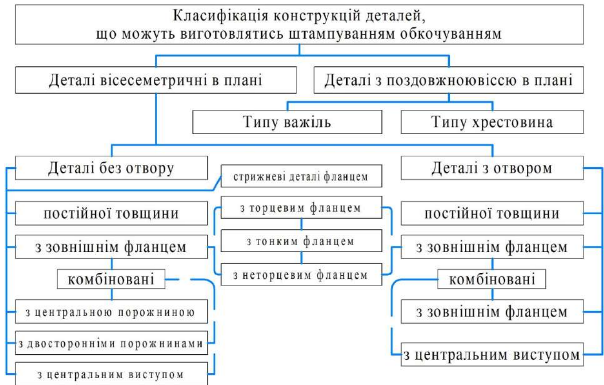
Рисунок 1.4 – Класифікація деталей за формою, що можуть ефективно виготовлятися методом ШО
