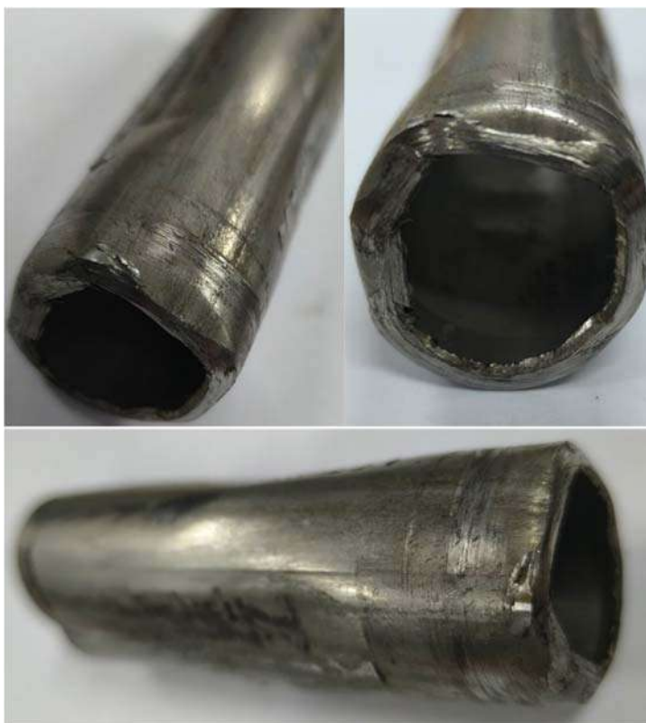
Рисунок 4.18 – Приклад заготовки з дефектами, що виникли внаслідок відхилення від параметрів процесу ШО
