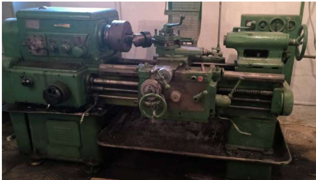
Рисунк 4.10 – Токарно-гвинторізний верстат моделі 1К62, оснащений оригінальною обкочувальною приставкою
