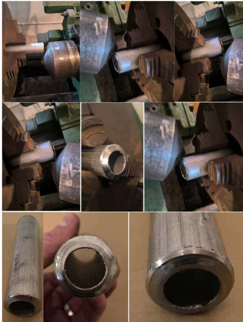
Рисунок 4.17 – Початкова, проміжна та завершальні стадії формування сфери стакан
