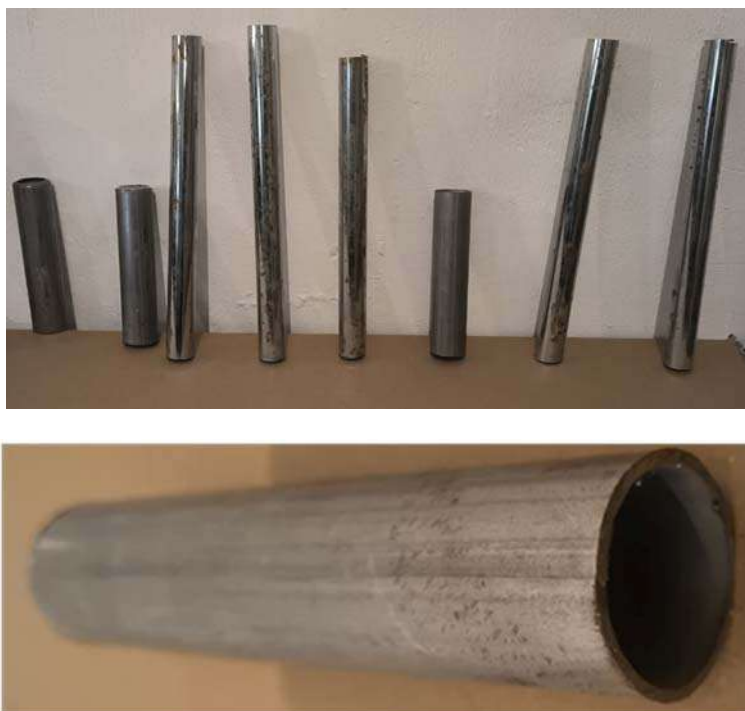
Рисунок 4.16 – Трубні заготовки різної довжини для фізичного моделювання із тонкостінної вуглецевої сталі покритої нікелем та із нержавіючої сталі
