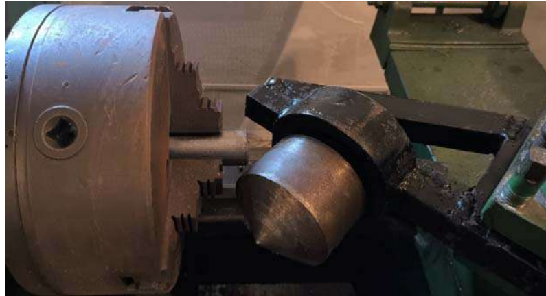
Рисунок 4.13 – Вигляд робочої зони під час ШО трубної заготовки на токарно-гвинторізному верстаті, оснащеному обкочувальною приставкою
